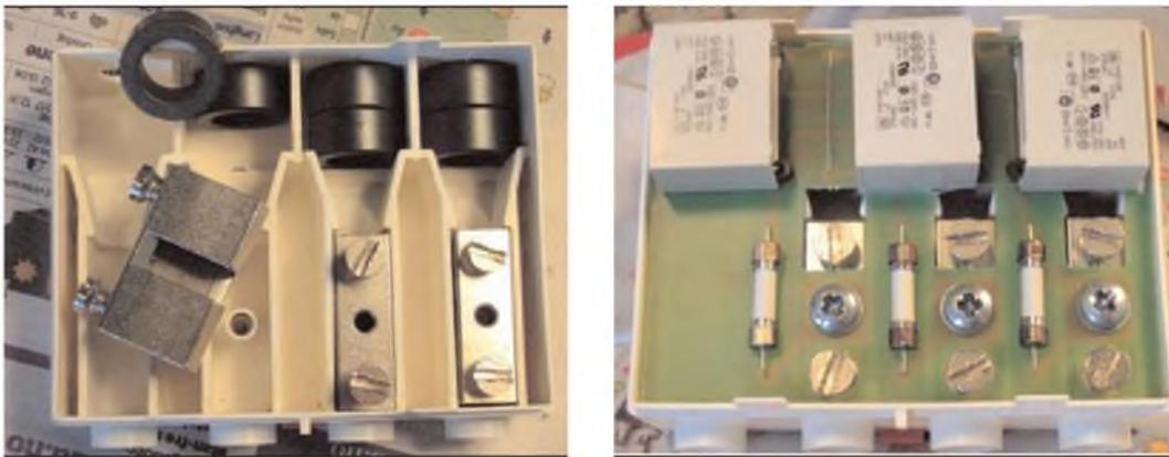
Figure 62 : Le filtre Nobø, la partie ferrite à gauche et la partie condensateur et fusible à droite.
